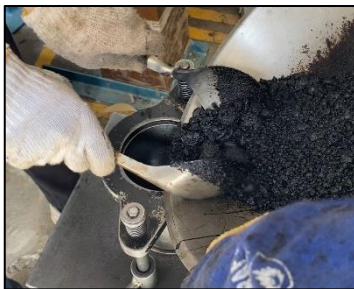
Gambar 5. 5 Pemindehan benda uji ke Compactor
