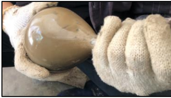
Gambar 3. 9 Mengeluarkan gelembung udara
