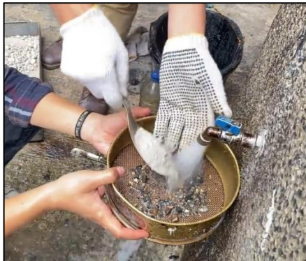
Gambar 3. 20 Penyaringan benda uji yang lolos saringan #12
